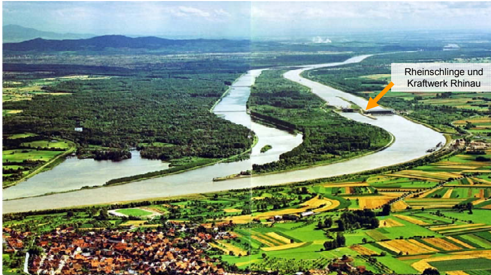
Im Rheinseitenkanal und in den Schlingen: Abflussdrosselung in der kanalisierten Strecke führt zu Ausuferung und Retention im natürlichen Flussbett.
