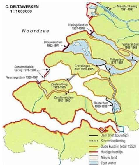
Abbildung 3: Ästuar mit Dämmen und Sturmflutsperrwerken
