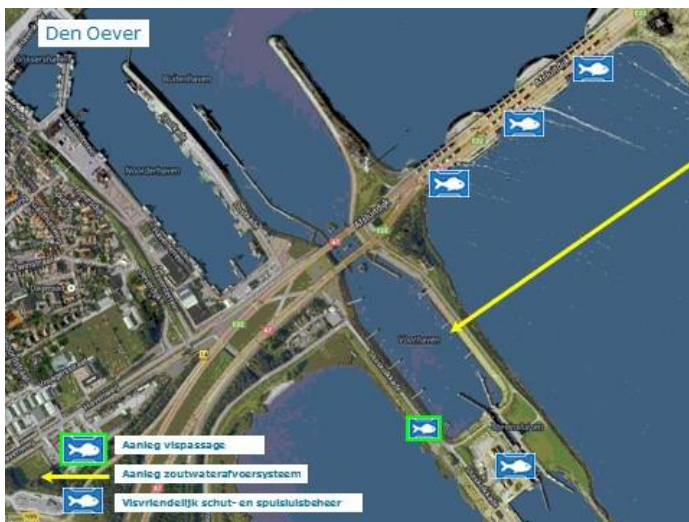
Abbildung 12: Lage der Maßnahmen Den Oever. Bau des Fischpasses (= Aanleg vispassage), Bau des Salzwasserabflusssystems (= Aanleg zoutwaterafvoersysteem), fischfreundlicher Schiffsschleusen- und Sielbetrieb (=visvriendelijk schut- en spuilsuisbeheer)
