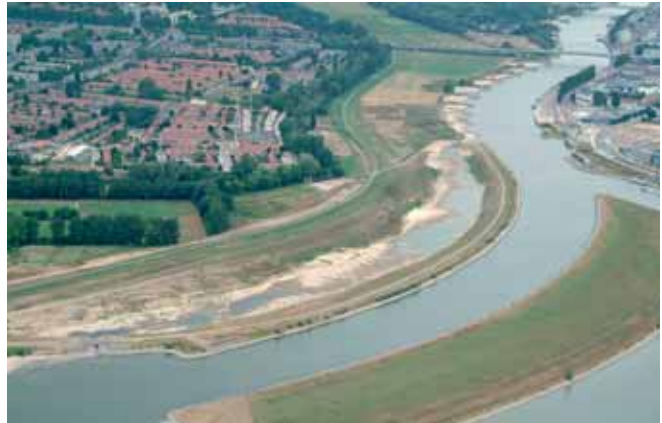
Combinatie van hoogwaterbescherming en natuurontwikkeling: de dijkverlegging "Bakenhof" (fotografie: B. Boekhoven, NL)
