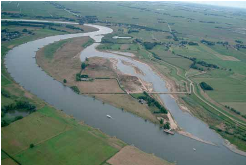
Figuur 3: Realisatie van een systeem van nevengeulen aan de IJssel dat voldoet aan het streefbeeld (Vreugderijkerwaard) (fotografie: B. Boekhoven, NL)
