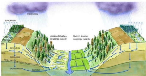
Figuur 11: Principe van de "spons" als natuurlijke waterretentie (figuur uit de presentatie van Bas Roels over het Sponge Project)
